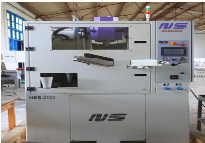
Picha Na. 14: Mashine ya kisasa ya kutengeneza vyungu (crucibles) vya kuyeyushia sampuli za miamba na udongo.
